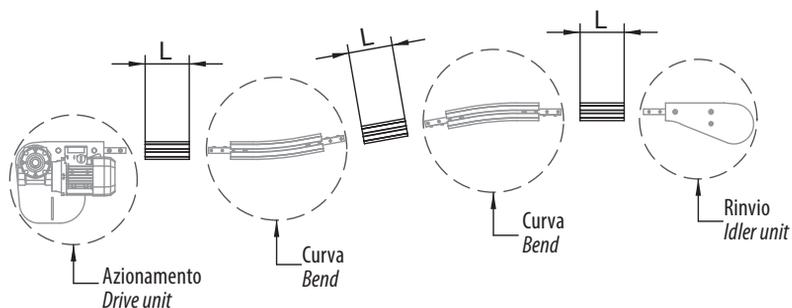
L = 160 mm (lunghezza minima della trave) - L = 160 mm (minimum beam's length)
