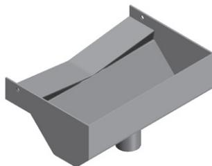
I gocciolatoi vengono utilizzati per impedire l'accesso al lato inferiore del convogliatore per eliminare il rischio di lesioni personali e come punti di raccolta per proteggere il pavimento e i componenti dalle gocce in caso di trasporto di elementi oleosi o bagnati.
