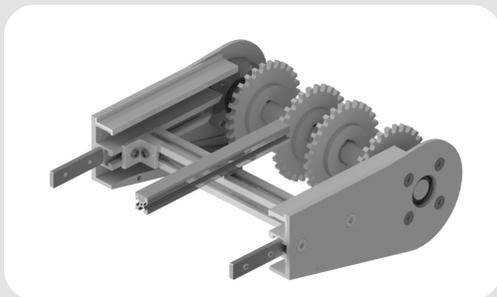
Gruppo di rinvio 180° fornito nella versione con fiancate di sicurezza. Disponibile la soluzione con albero sporgente per l'utilizzo del gruppo rinvio come stazione di azionamento (versione per catena in acciaio non fornibile). Il gruppo rinvio è provvisto di catena guidata inferiormente per evitarne il deragliamento. Viene spedita completamente assemblata e gli elementi per il fissaggio sono inclusi.
