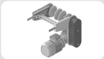
Stazione di azionamento diretta verticale di testa con ritorno catena sulla parte inferiore. Ne è previsto l'uso in abbinamento ad un gruppo rinvio a 180°. Disponibile nelle versioni con o senza motore, sia diretto sia rinviato, e nelle versioni destra o sinistra in riferimento al senso di marcia. Viene spedita completamente assemblata e gli elementi per il fissaggio sono inclusi.
