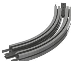
Le curve senza ruota vengono utilizzate per i cambiamenti di direzione orizzontali che avvengono sul piano. Sono composte da un unico corpo in PE per il raggio 200 mm. Curve con raggi speciali sono generalmente composte da semitravi calandrate e distanziali di unione.
