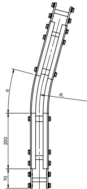
N.B. La lunghezza della guida di scorrimento necessaria è il doppio della lunghezza della catena. N.B. *The required slide rail length is twice the length of the chain.*
