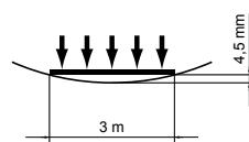
Le travi per il convogliatore FL 85 INOX sono realizzate con un profilo in Acciaio INOX 1.4301, fornito in barre standard da 3000 mm da tagliare in sezioni della lunghezza necessaria. Il profilo può essere fornito con lunghezze a richiesta.
