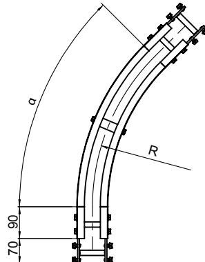
N.B. La lunghezza della guida di scorrimento necessaria è il doppio della lunghezza della catena. N.B. The required slide rail length is twice the length of the chain.
